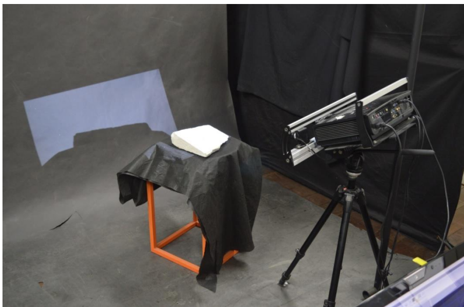
Figura 3: Scanner RangeVision Advance escaneando a estela de Renesonb. Inv 642. CR:16.
