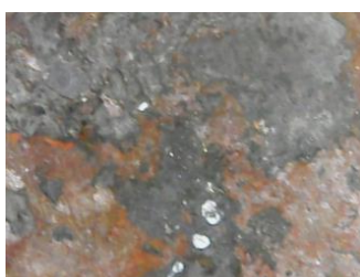
Imagens 25 e 26: Exposição do Cobre-Cu 2 O- Cuprita.
