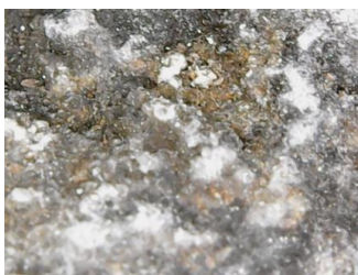
Imagem 9: Exposição do Cobre - Cu_2O - Cuprita e possibilidade da formação de sais de Chumbo (Tóxico).
