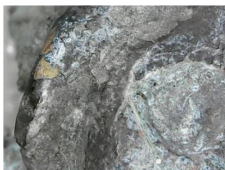
Imagem 19: Estrias – mudança de estrutura do metal.
