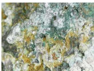
Imagem 5: Malaquita \text{CuCO}_3 \cdot \text{Cu}(\text{OH})_2
