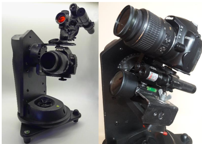
Figura 11 e Figura 12: Primeira configuração de ELAP-1 (10). Algumas adaptações no decorrer dos testes foram aplicadas como lentes de observação solar, melhor compactação de cabeçote de lentes (11). Fotos do autor.
