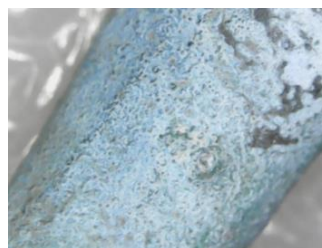
Imagem 20: Brochantita \text{CuSO}_4 \cdot 3\text{Cu}(\text{OH})_2 .
