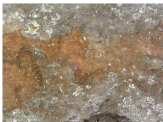
Imagem 10: Cu_2O Cuprita. Em presença de água Cu(OH)_2 .
