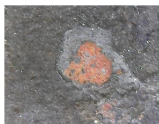
Imagens 25 e 26: Exposição do Cobre-Cu 2 O- Cuprita.
