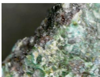
Imagens 3 e 4: Sais de cobre e possibilidade da formação de sais de Chumbo (Tóxico)
