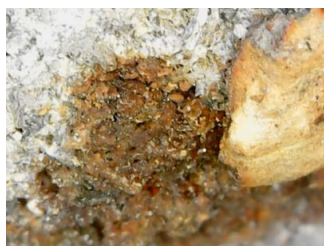
Imagem 16: Exposição do Cobre-Cu 2 O- Cuprita.
