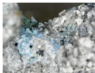
Imagem 6: Brocantita \text{CuSO}_4 \cdot 3\text{Cu}(\text{OH})_2
